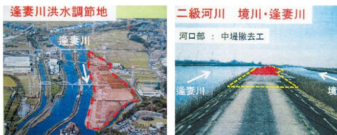
◎境川と逢妻川→「5年に一度発生する降雨」に対応する整備が2018年度に完了。現在は更なる治水安全度の向上を目指し、河口部より「20年に一度発生する降雨」に対応する整備を進めている。また、河床掘削や両河川の間にある中堤の撤去を実施している。
